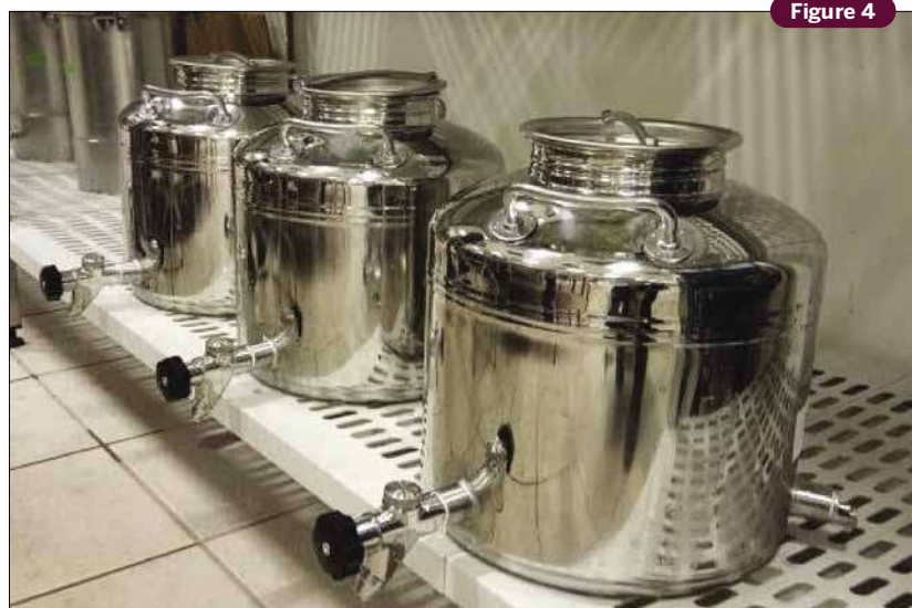
Cuves expérimentales équipées de trois robinets différents, situés en partie basse des cuves, tous au même niveau.
